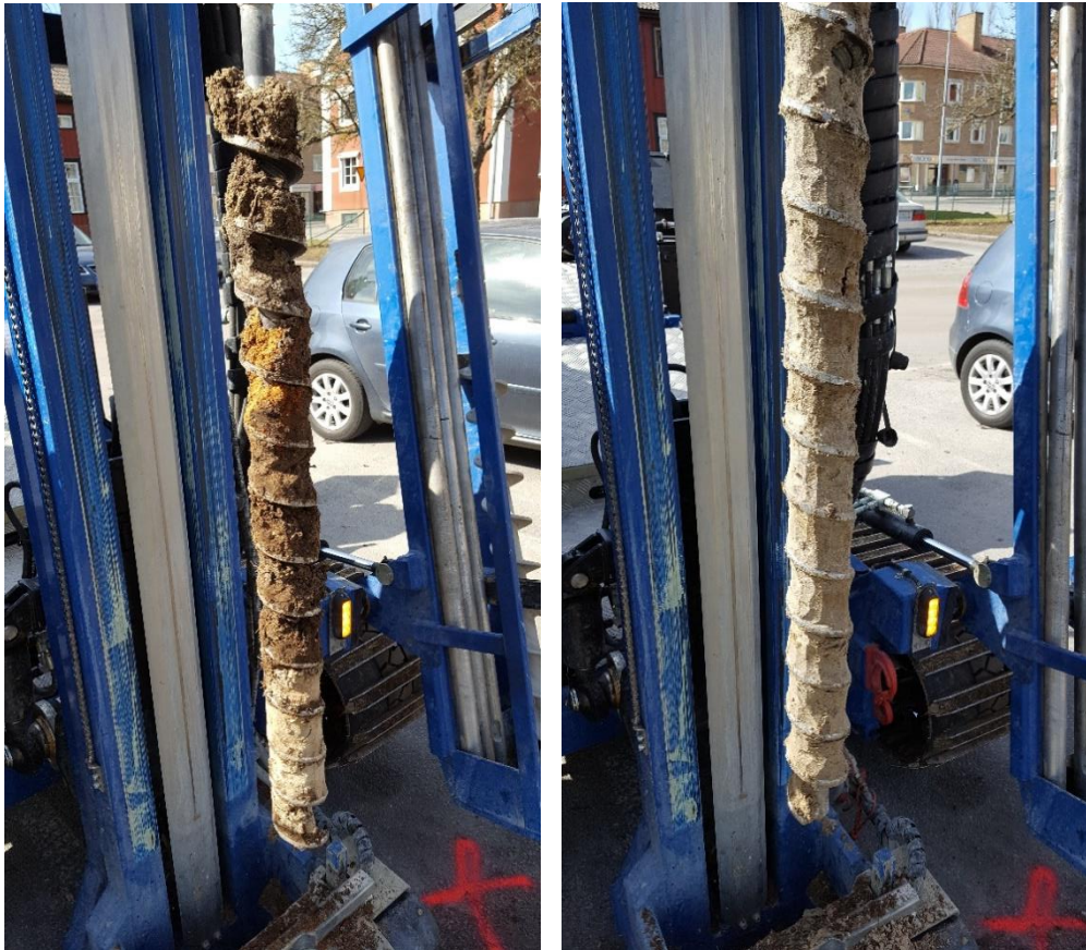
Figur 3. Jordprovtagning i punkt 1805 med skruvborr på bandvagn med markprofilen på 0,05–1,0 m djup till vänster (fyllning) respektive 1,0–2,0 m djup till höger (silt).
